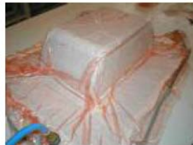
Réalisation de la bâche à vide. Making the vacuum bag.
