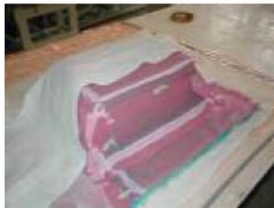
Préparation de la bâche à vide. Preparation of the vacuum bag.
